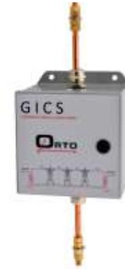
El Sensor de Corrientes Geomagnéticas Inducidas mide el valor de la corriente quasi DC que circula en los devanados del transformador. La barra de cobre está conectada entre la bobina del núcleo y la conexión a tierra del transformador.
